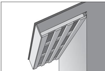
Монтаж обрешетки под установку панелей и направляющих. Две доски обрешетки монтируются по краям свеса, остальные доски монтируются с шагом не более 300 мм. Последующий монтаж производится аналогично первому способу.
