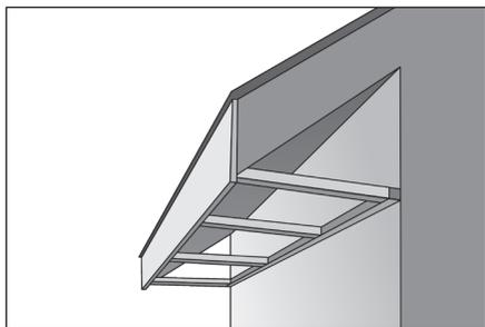
**1.1.** Устройство каркаса под обрешетку. Для этого необходимо установить брусок на фасаде по уровню нижнего края свеса крыши. Затем установить бруски, соединяющие фасад и свес крыши. Бруски между собой соединить при помощи металлических уголков и пластин.
