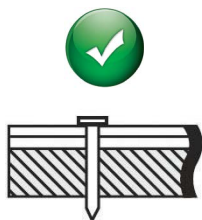
Рис. 2 Пример правильной забивки гвоздей при монтаже продукции.
